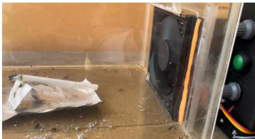
Pengujian efektivitas alat pendeteksi CO pada asap rokok
