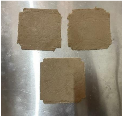
Membran Selulosa Asetat dari Serat Selulosa Lidah Mertua
