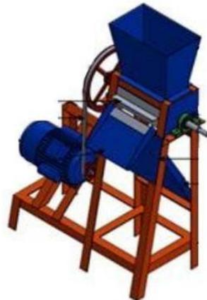
Gambar 2.2 Mesin pengupas kulit kopi dengan menggunakan motor listrik
