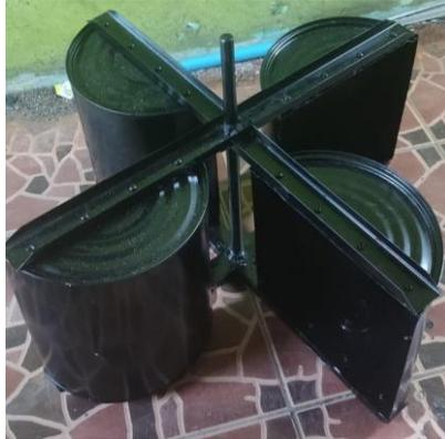
**Gambar 2. 2** Turbin Angin Sumbu Vertikal
