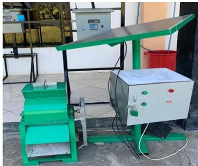
**Gambar 2. 1** Mesin Pencacah Plastik
