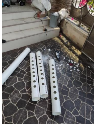
Pengeboran pipa PVC untuk tempat tanaman
