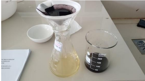
Filtrasi abu tongkol jagung setelah direndam dengan NaOH 4M
