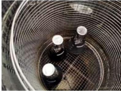
Proses Hidrotermal Suhu 121°C Selama 18 Jam
