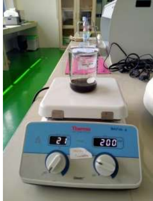
Pengadukan 200 rpm KA suhu 70°C
