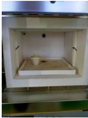
Proses Kalsinasi Suhu 250°C Selama 1 Jam
