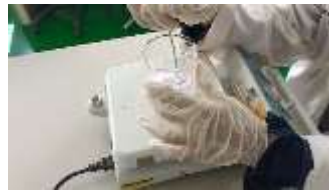
Pemanasan dan Pengadukan Campuran Bioplastik
