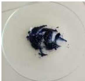
Pengujian Iodin Pada Pati Kentang
