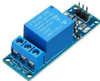
**Gambar 7 Modul Relay 5V**
