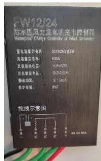
Gambar 2. 2 Wind Turbine Controller (Sumber: Dok.Pribadi, 2024)
