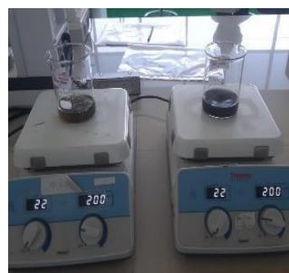
Pengadukan hasil komposit dan larutan naphthol yellow dengan magnetic stirrer
