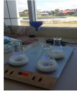
Pengadukan serbuk ZnO, Etanol pa dan Aquademin dengan magnetic stirrer
