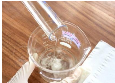
Proses ekstraksi dengan penambahan larutan H 2 SO 4
