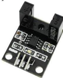
Gambar 2.6 Sensor Kecepatan LM393[9]
