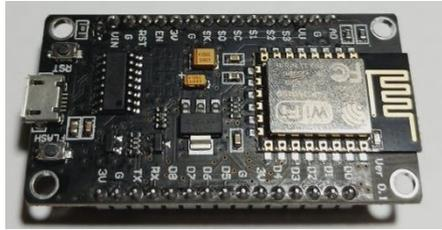
Gambar 2. 1 NodeMCU 8266
