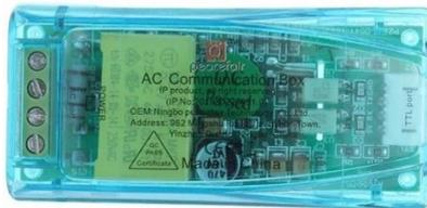
**Gambar 2. 10 Modul PZEM-004T****Tabel 2. 10 Spesifikasi Pzem-004T**
