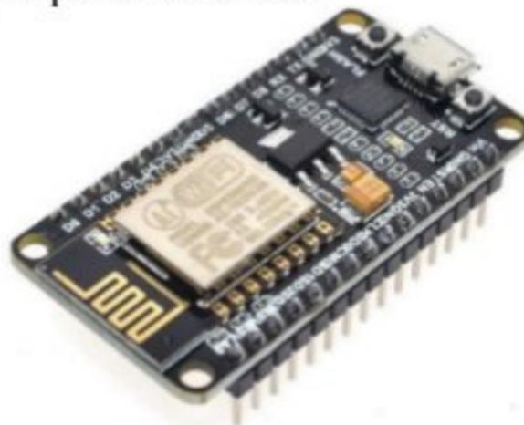
Gambar 2.6 NodeMCU ESP 8266
