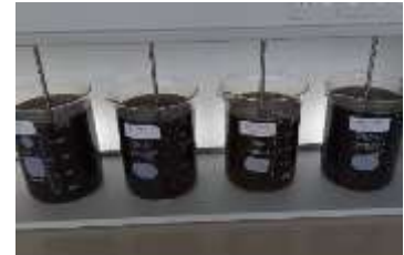
Proses Jar test aplikasi biokoagulan
