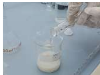
Uji kelarutan kitosan
