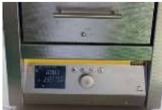
Proses kalsinasi 900 °C 4 jam dan 5 jam
