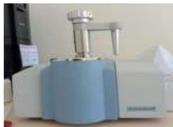
**Gambar 2.4** Instrumentasi FTIR Spesifikasi Bruker Alpha II Platinum-ATR
