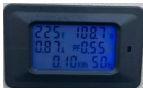
**Gambar 2.7 Watt Meter Digital**
