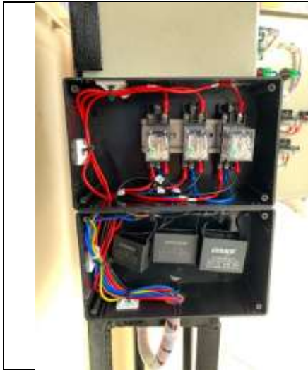
Rangkaian kapasitor dan relay DC 12 V
