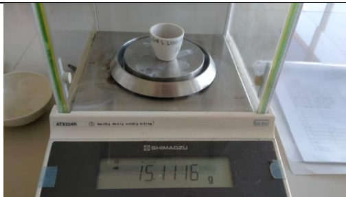
Menimbang krus kosong untuk analisis kadar air
