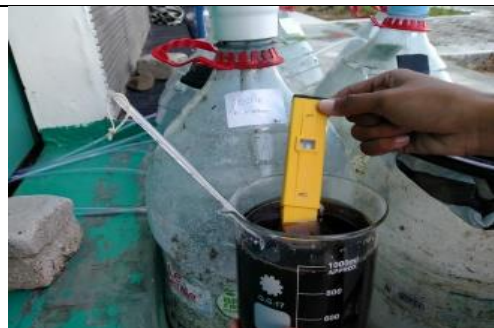
Mengukur pH dengan pH meter dan mengukur suhu dengan termometer
