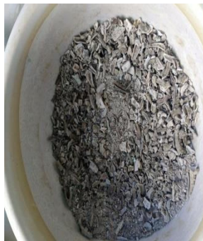
Sampel Cangkang Kepiting yang ditumbuk agar sedikit halus
