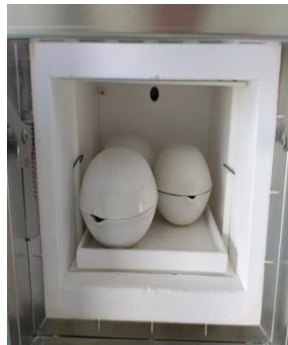
Kalsinasi Cangkang Kepiting pada Suhu 700°C dan 800 °C
