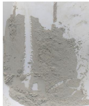
Sampel Cangkang Kepiting yang sudah di haluskan dengan ayakan 150 mesh
