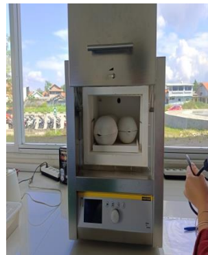
Kalsinasi Cangkang Kepiting Lunak Pada Suhu 700 °C dan 800 °C Selama 2 jam
