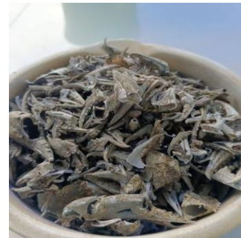
Sampel Cangkang Kepiting lunak setelah dikalsinasi
