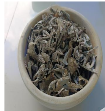
Sampel Cangkang Kepiting Lunak yang sudah di Kalsinasi
