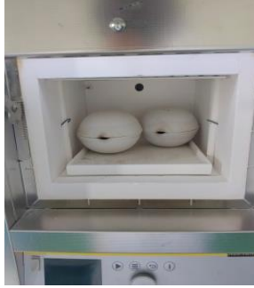
Sintesis Biokoagulan pada suhu 750 °C selama 1 jam
