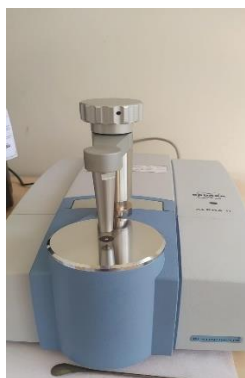
Gambar 2.6 Instrumentasi Fourier Transform Infra Red (FTIR) spesifikasi Bruker Alpha II Platinum-ATR
