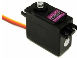
Gambar 2. 10 Motor Servo Tabel 2. 6 Spesifikasi Motor Servo
