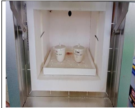
Pengujian Kadar Volatil Meter dengan Furnace
