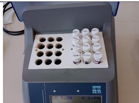
Pengujian Parameter COD dengan menggunakan Detector COD
