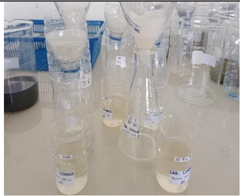
Penyaringan Air Limbah Laundry untuk Pengukuran Parameter TSS
