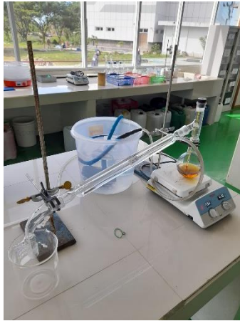
Proses destilasi hasil ekstrak bahan baku selama 4 jam
