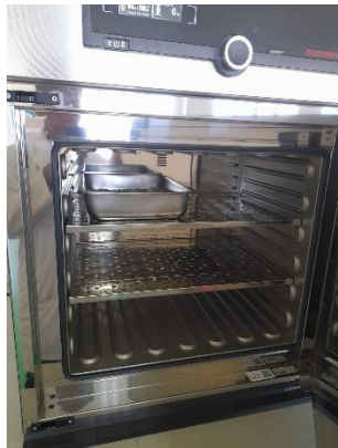
Proses oven bahan baku suhu 115°C selama 4 jam
