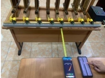
Gambar F. 6 Pengujian Kesesuaian Nada
