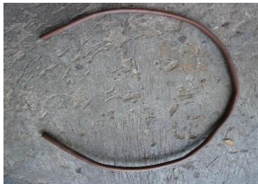
Gambar 2. 7 Pipa Kapiler (sumber: dokumen pribadi, 2023)
