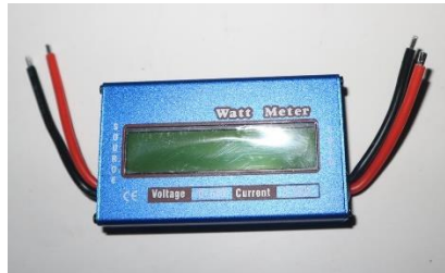
Gambar 2. 4 Digital Wattmeter DC (sumber: dokumen pribadi, 2023)
