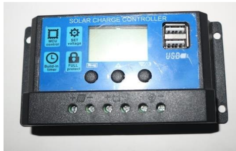
Gambar 2.3 Solar Charge Controller (sumber: dokumen pribadi, 2023)
