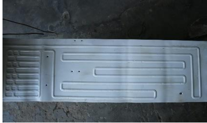
Gambar 2. 6 Evaporator (sumber: dokumen pribadi, 2023)
