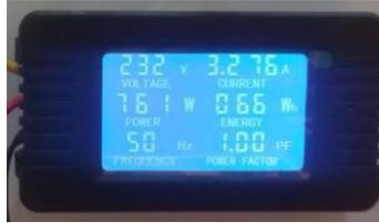
Gambar 4. 29 Pengukuran Kinerja Dua Beban Seterika dan Lampu Pijar
