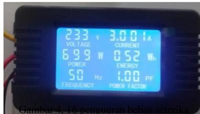
Gambar 4. 28 Pengukuran daya Kerja Beban Seterika Listrik
