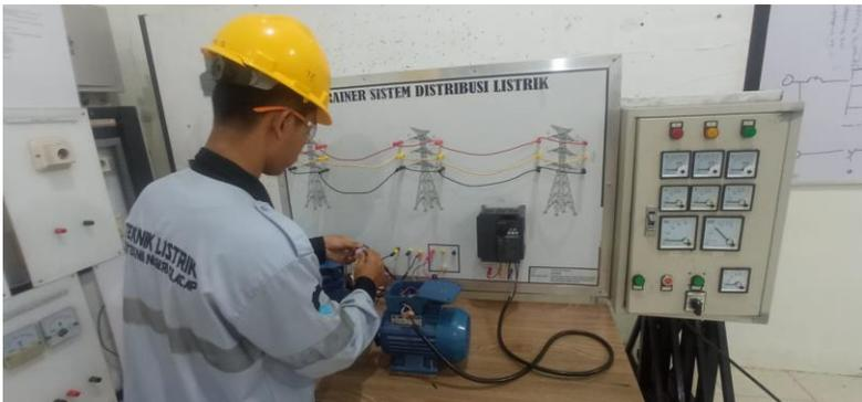
Gambar Ujicoba Simulasi pembebanan Induktif motor 3 fasa
