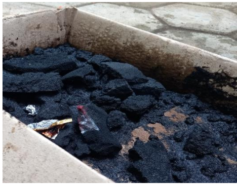
Hasil karbonisasi ampas kopi pada suhu 250°C selama 45 menit.
