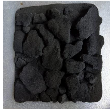
Hasil karbonisasi ampas kopi pada suhu 200°C selama 45 menit.
