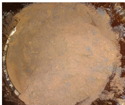
Hasil karbonisasi ampas kopi pada suhu 100°C selama 1 jam.
