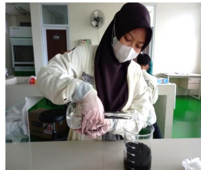
Proses pencampuran karbon aktif dengan larutan KOH dengan perbandingan 100 gr karbon dengan 500 ml larutan KOH.
