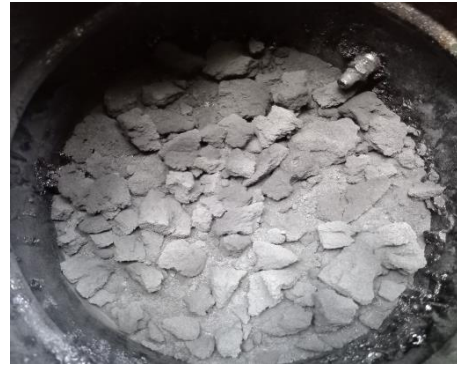
Hasil karbonisasi ampas kopi pada suhu 200°C selama 2 jam.
