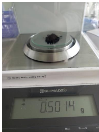
Penimbangan karbon aktif 0,5 gram untuk pengujian daya serap iodin.
