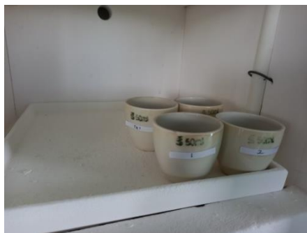
Proses Pengujian Karakteristik Karbon Aktif berupa Kadar Abu.
