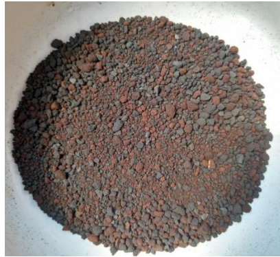
Hasil karbonisasi ampas kopi pada suhu 150°C selama 1 jam.
