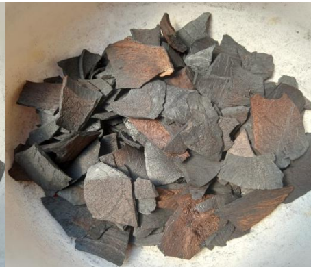
Hasil karbonisasi tempurung kelapa pada suhu 200°C selama 3 jam.
