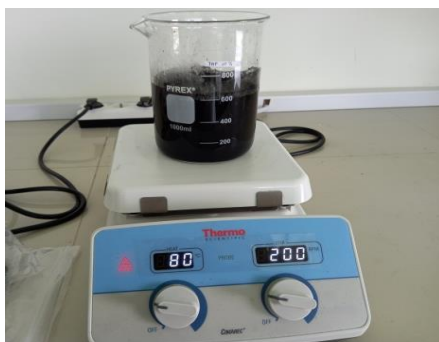
Proses pengadukan (homogen) dengan kecepatan 200 rpm dan suhu 80°C.
