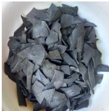
Hasil karbonisasi tempurung kelapa pada suhu 300°C selama 3,5 jam.
