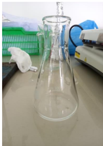
Setelah dilakukan titrasi dengan Natrium Thiosulfat 0,1N kembali.
