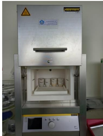
Proses Pengujian Karakteristik Karbon Aktif berupa Kadar Zat Mudah Menguap (volatil)
