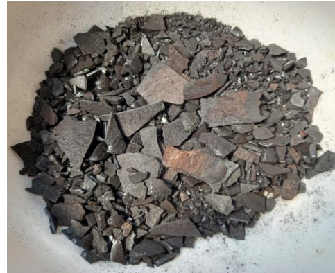
Hasil karbonisasi tempurung kelapa pada suhu 250°C selama 1,5 jam
