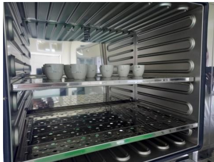
Proses Pengujian Karakteristik Karbon Aktif berupa Kadar Air.
