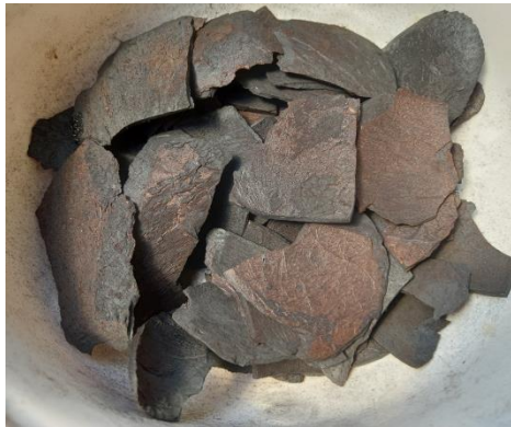
Hasil karbonisasi tempurung kelapa pada suhu 220°C selama 2,5 jam.
