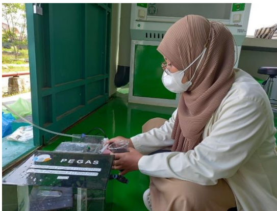
Proses memasukan karbon aktif pada alat penunjang "PEGAS"
