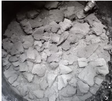
Hasil karbonisasi ampas kopi robusta pada suhu 200 °C selama 2 jam
