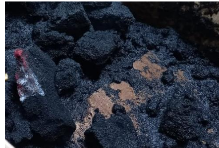
Hasil karbonisasi ampas kopi robusta pada suhu 250 °C selama 45 menit
