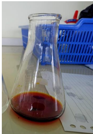
Penambahan larutan iodin 0,1 N pada sampel karbon
