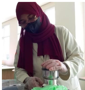
Proses penghalusan arang ampas kopi robusta dan tempurung kelapa
