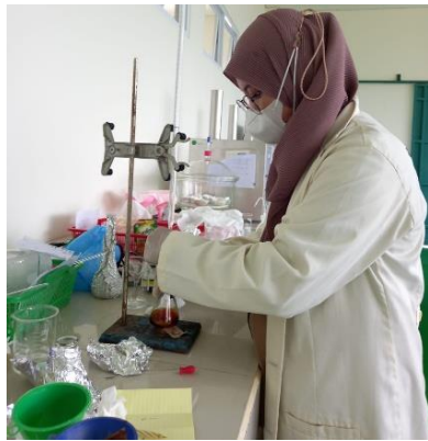
Proses titrasi daya serap iodin
