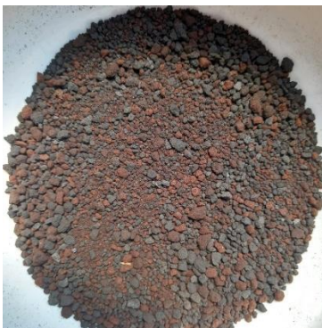
Hasil karbonisasi ampas kopi robusta pada suhu 200 °C selama 30 menit
