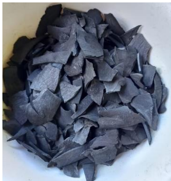
Hasil karbonisasi tempurung kelapa pada suhu 300 °C selama 3,5 jam
