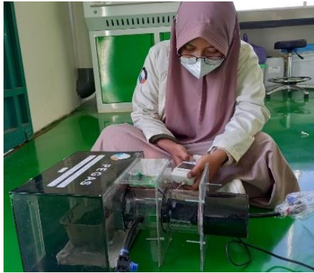
Pengujian kebocoran alat dengan Odor Meter
