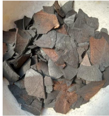
Hasil karbonisasi tempurung kelapa pada suhu 200 °C selama 3 jam
