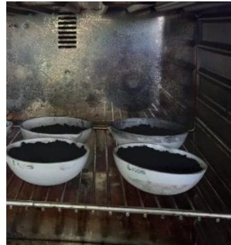
Pengeringan karbon aktif setelah netralisasi menggunakan oven
