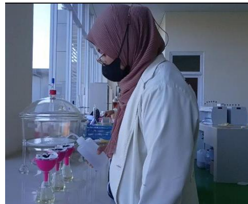
Proses pencucian karbon aktif hingga pH netral (netralisasi)
