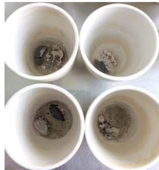
Hasil uji kadar zat mudah menguap sebelum aktivasi
