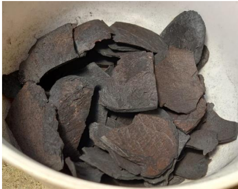
Hasil karbonisasi tempurung kelapa pada suhu 220 °C selama 2,5 jam
