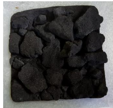
Hasil karbonisasi ampas kopi robusta pada suhu 200 °C selama 45 menit
