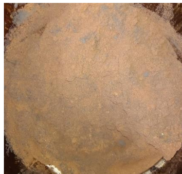
Hasil karbonisasi ampas kopi robusta pada suhu 100 °C selama 1 jam
