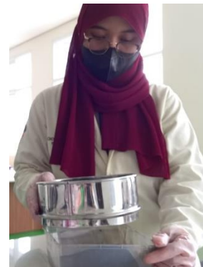
Proses pengayakan arang ampas kopi robusta dan tempurung kelapa dengan ukuran 100 mesh
