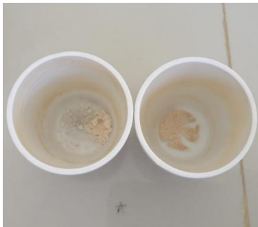
Hasil uji kadar abu setelah aktivasi
