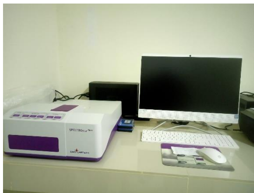
Gambar 2. 7 Spektrofotometer UV-Vis ( Sumber: Peneliti )
