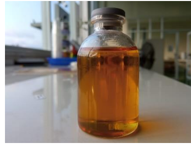
Minyak setelah adsorpsi menggunakan karbon aktif teraktivasi \text{Ca}(\text{OH})_2
