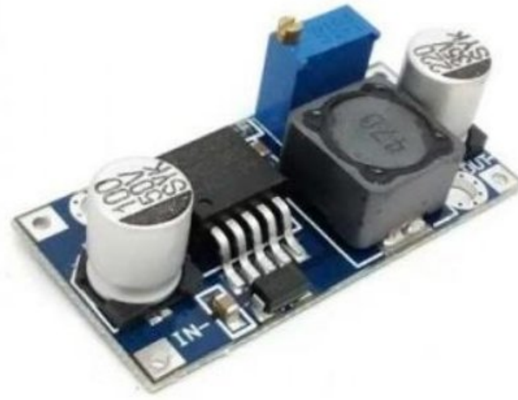
Gambar 2. 4 Spesifikasi DC Converter LM2596
