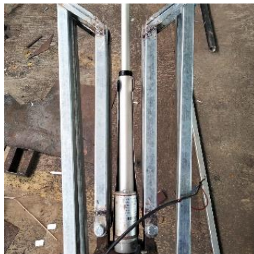
Gambar 2. 16 Motor Linear Aktuaktor (Sumber : Dokumen Pribadi, 2023)
