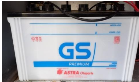
Gambar 2.11 Akumulator (Sumber : Dok. Pribadi, 2023)
