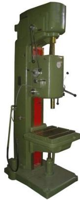
**Gambar 2.7** Mesin Gurdi *Vertikal*
