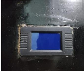
Gambar 2.9 Modul PZEM 015 Voltmeter DC
