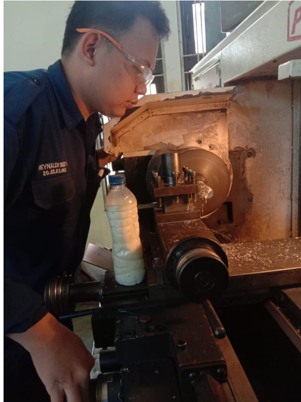
Proses pembuatan poros
