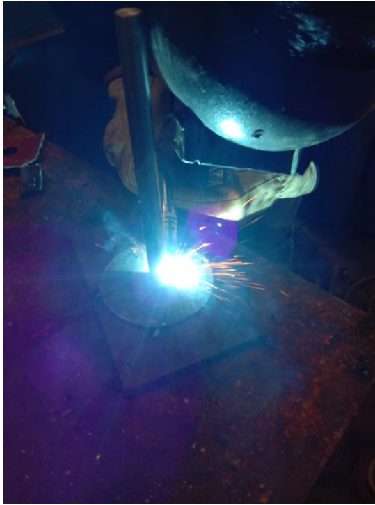
Proses pengelasan piringan engkol ke poros
