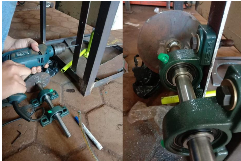
Proses pemasangan transmisi ke rangka
