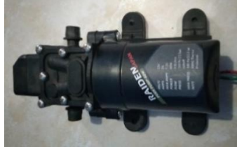
Gambar 2. 7 Pompa DC (Sumber : Dok. Pribadi, 2023)
