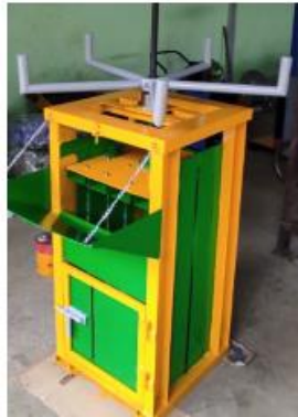
Gambar 2.2 Desain mesin press sampah botol plastik kemasan minuman (Ristiawan dan Naim, 2022)
