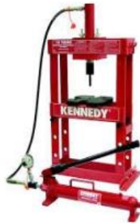
Gambar 2.3 Desain rangka mesin press hidrolik kapasitas 50 ton (Riki, Herisiswanto, dan Dedi, 2020)
