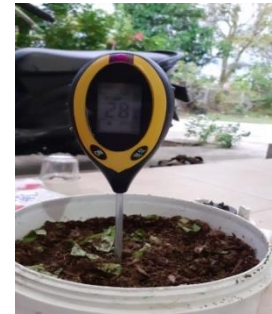
Pengukuran pH, suhu dan kelembapan
