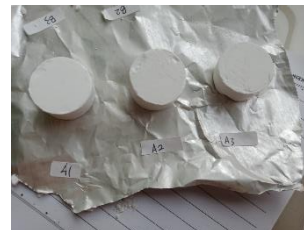
(Sampel untuk pengujian karakteristik koagulan menggunakan XRF)
