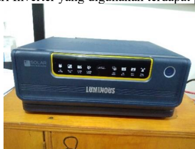
Gambar 2. 2 Inverter (Sumber : Dok. Pribadi, 2023)
