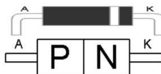
Gambar 2. 2 Bentuk dan simbol dioda (Pasaribu & Reza, 2021)
