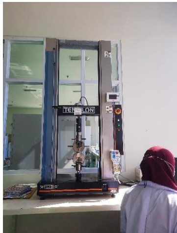
Pengujian Kuat Tarik dan Elongasi Membran
