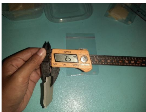
Pengujian Ketebalan Membran Menggunakan Jangka Sorong Digital
