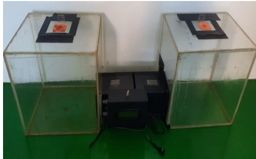
Rangkaian Tempat Penampung Asap Rokok dan Tempat Membran
