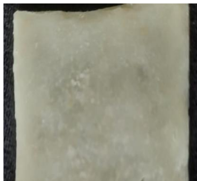
Membran Selulosa Asetat Sebelum Pengaplikasian pada Asap Rokok
