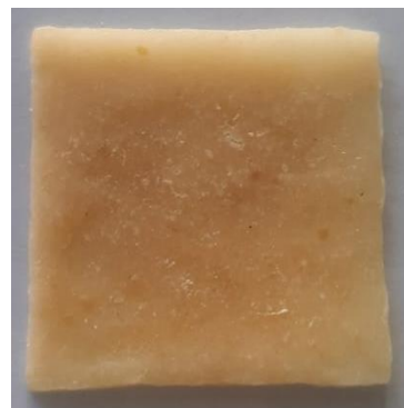
Membran Selulosa Asetat Setelah Pengaplikasian pada Asap Rokok
