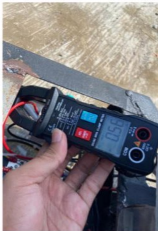
Gambar (d) Pengukuran Arus PV
