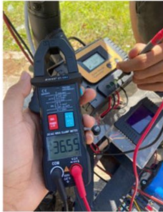
Gambar (c) Pengukuran Tegangan pengisian baterai
