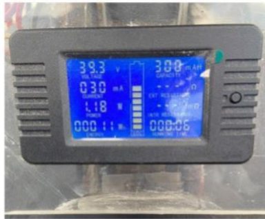
Gambar (e) Display pengukuran konsumsi energi baterai
