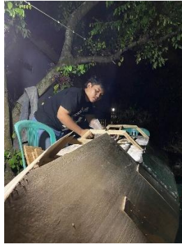
Gambar 2. Proses pemasangan triplek untuk body kapal
