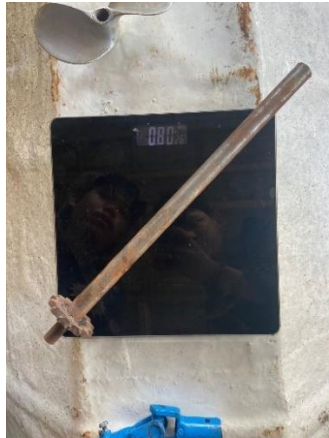
Gambar 4 Penimbangan beban shaft dan sprocket
