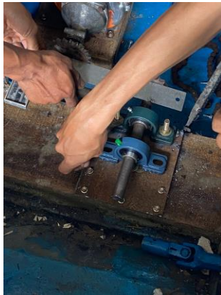
Gambar 14. Proses pemasangan rante ke sprocket
