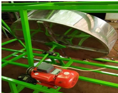
Gambar 2.2 Mesin disk granulator (Sucipto & Hendariyono, 2018)
